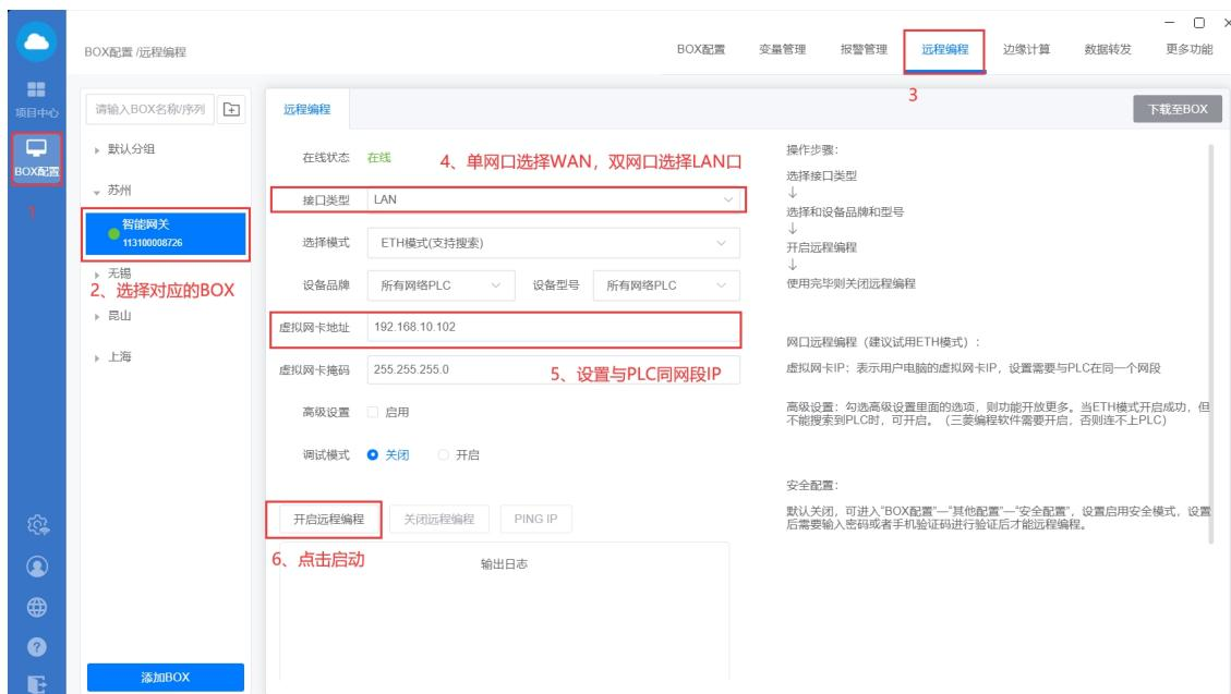
等待启动链接成功之后，则打开编程软件，开始远程上下载，监视PLC程序；
