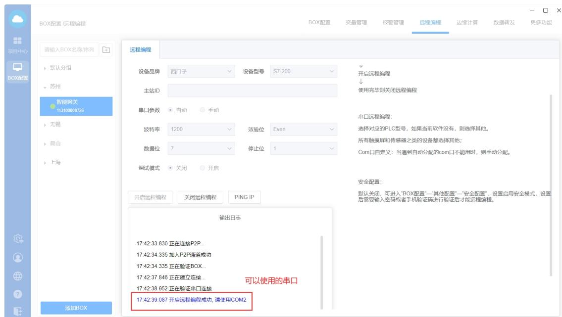
打开编程软件，开始远程上下载，监视PLC程序；
